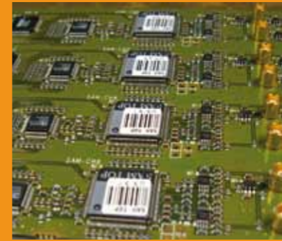
Figure 4 : Carte d'électronique frontale HESS 2. Vue de la partie amplification, mémoire analogique (SAM) et conversion.
