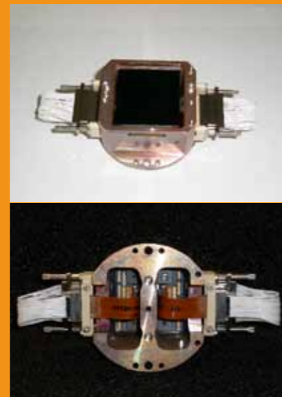
Figure 3 Prototype « mécanique » (test de planéité ...) de CCD pour LSST produit par E2V (mars 2010).
