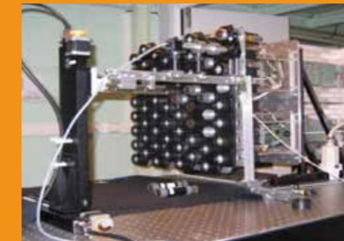
HESS 2 : Banc de test de contrôle des photomultiplicateurs.
