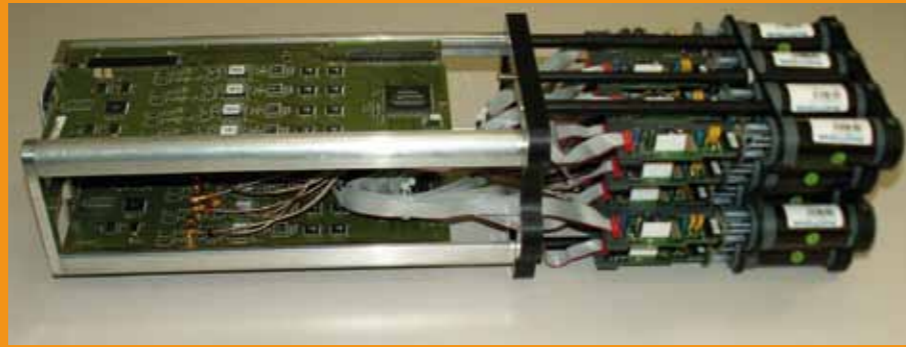
Figure 3 : Tiroir complet HESS 2, équipé de ses 16 photomultiplicateurs.
