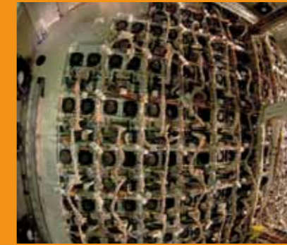
Figure 5 : Vue du câblage de la partie centrale de la caméra.
