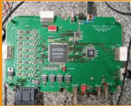
Figure 2 : Carte Back End du banc de test ASPIC (LSST).
