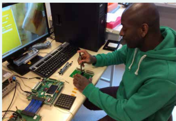
Tests de production de l'ASIC analogique de lecture des CCD : l'ASPIC.
