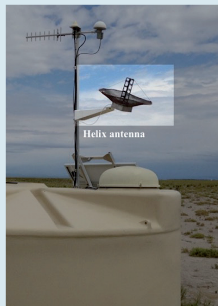
Photo d'une des antennes hélix installée sur un des détecteurs de surface de l'Observatoire Pierre Auger. Ces détecteurs radio pourront peut-être apporter un nouveau moyen de mesure des grandes gerbes atmosphériques.
