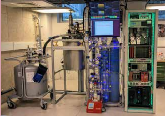
Photo 3 : Vue du dispositif expérimental XeLab, avec de gauche à droite, le réservoir d'azote liquide, le cryostat incluant la TPC, le système de purification et de stockage du xénon et le système d'acquisition des données et d'alimentation des hautes tensions.
