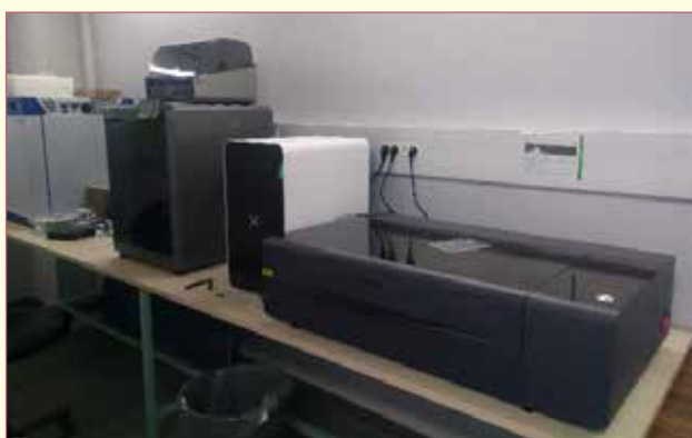
Machines du FabLab nouvellement aménagé, en premier plan découpeuse laser et son système de filtration, en arrière-plan l'imprimante 3D à filaments.
