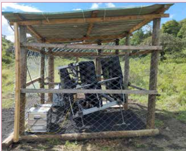
Un détecteur de muons installé dans la chaîne des Chyulu au Kenya. Le détecteur est constitué de trois plans de scintillateur plastique afin de reconstruire la trajectoire des muons ayant traversé une colline de la chaîne.
