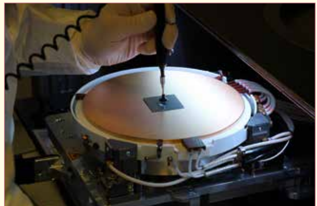
Photo 3 : Chargement d'un module nu ITk sur plateau du testeur sous pointes.
