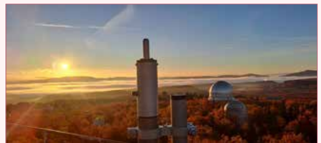
Photo 1 : Au premier plan l'étoile artificielle StarDICE protégée par son enceinte cylindrique. L'enceinte s'ouvre la nuit pour que l'étoile artificielle serve d'étalon au télescope robotique abrité par la première coupole à gauche au deuxième plan.
