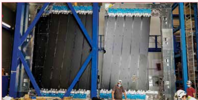
Photo 2 : Le détecteur SciFi pendant la phase de montage dans la cave de l'expérience LHCb. On note le passage aménagé pour le tube à vide du LHC. On distingue une partie de l'électronique de Front End (en bleu), aux deux extrémités des modules à fibres scintillantes du SciFi.
