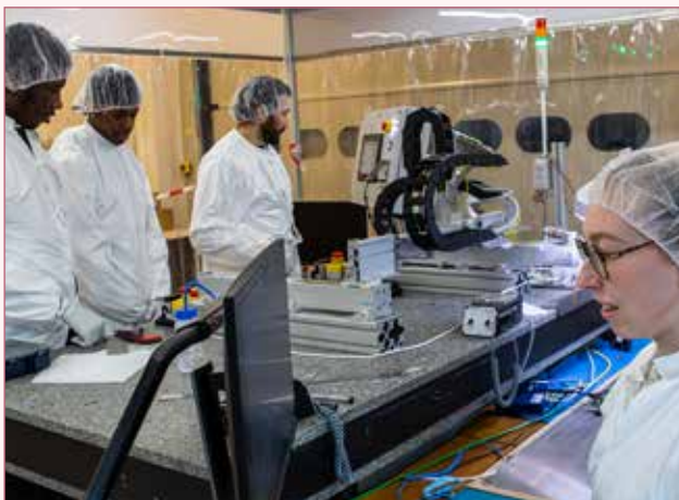
Une partie de l'équipe HGTD mettant en œuvre l'automate d'assemblage des unités HGTD et opérant le banc de tests électriques de contrôle des modules.
