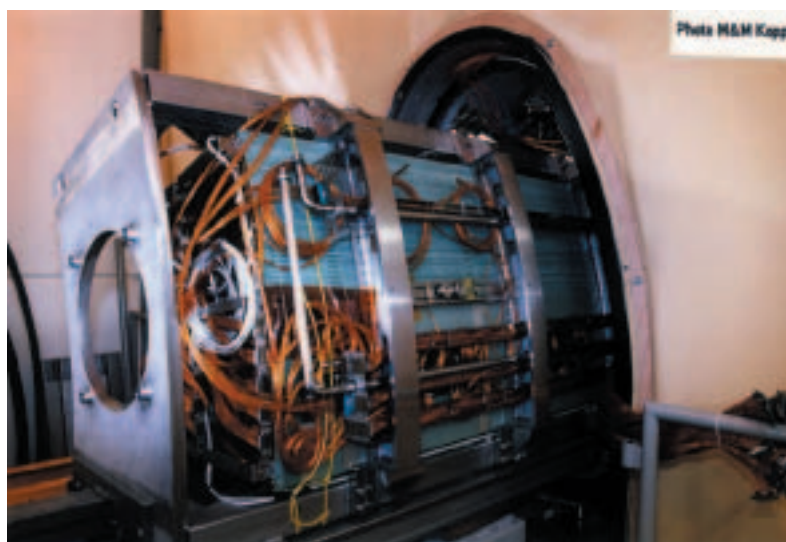
Figure 1 : module de série du calorimètre électromagnétique à Argon liquide lors de son insertion dans le cryostat utilisé pour les tests en faisceaux.
