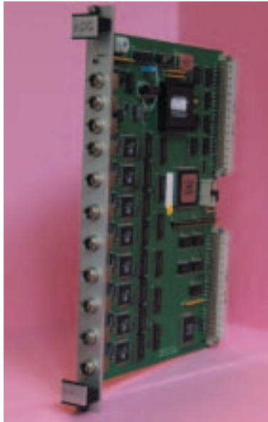
Figure 4 : carte ADC du luminomètre et du polarimètre de l'expérience H1.
