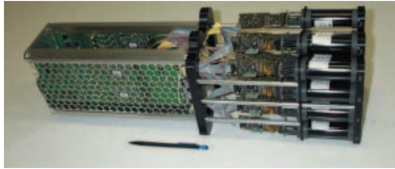
Figure 5 : tiroir d'électronique de hébergeant 16 photomultiplicateurs et deux cartes analogiques de la caméra de l'expérience HESS.
