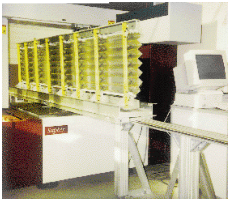
Fig. 2. Dispositif de mesure de la géométrie des absorbeurs.
