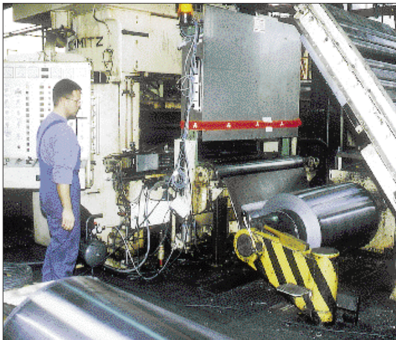
Système de radiographie du plomb installé sur le laminoir.
